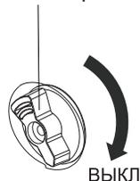
Ручка вентиляционного клапана на крышке заправочной горловины
