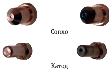
Рис. 7.6. Износ сопла и катода.
